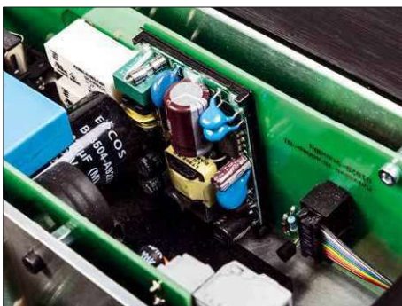
Das ist das PFC-Modul, dass am Netzeingang sitzt und eine stabile Gleichspannung generiert ...
