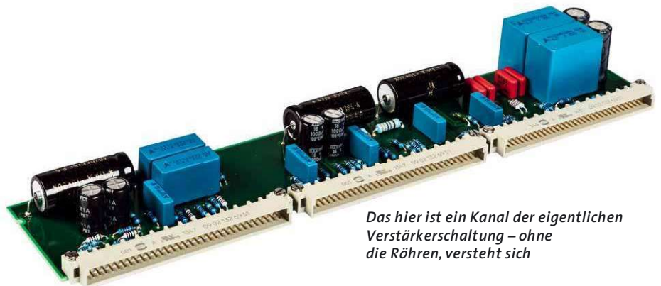
Die konsequent modular aufgebaute Schaltung ist mit reichlich Relais bestückt
